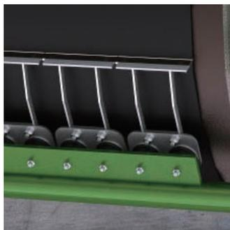
安全面においては、ストッパーナットとストッパーボルトを装備しており、二重の安全構造により、巻き込み事故を起こしにくい構造になっております。
