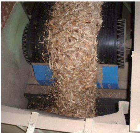
クリーナブレードがポリウレタン製なのでベルトに優しく馴染みます。ベルトの保全を第一に考えられるユーザー様には最適です。大きな塊がクリーナを直撃する様な現場でも安全にお使い頂けます。クリーナとベルト面とのクリアランスを広く設計しておりますので搬送物の詰まりや堆積による掻取効果の減少を防ぐことができます。圧縮バネを使用してブレード摩耗による掻取効果の減少にも自動で調整して対応しますのでメンテナンスに掛かる時間を短縮できます。ブレード交換が容易でメンテナンスに掛かる時間を短縮します。正逆転コンベアにも対応しております。
